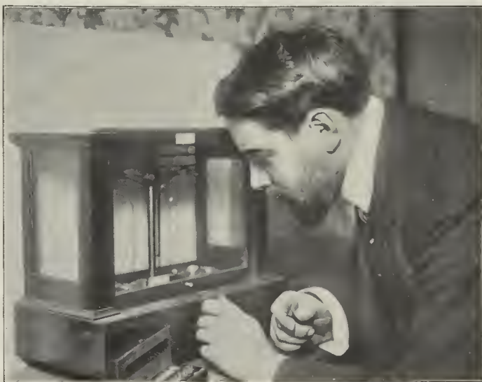
El inventor del procedimiento Luis Paris pesando en la balanza de precisión los polvos de alúmina y de óxido colorante de que se compone el polvo que se transformará en zafiro
